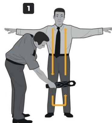
Если длина датчика (активная зона сканирования) металлоискателя меньше половины ширины тела досматриваемого (например, модель тактического металлоискателя ВМ-311), то алгоритм должен быть изменен в сторону увеличения проходов по вертикали со смещением, чтобы вся поверхность тела была в зоне сканирования.
